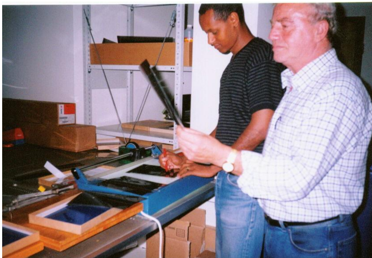
Рис. 41. Ретуширование карт на пленке
